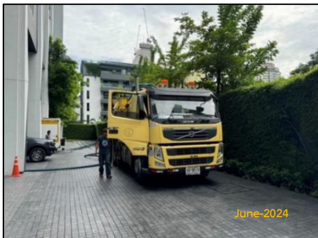
รูปที่ 2-13 การสูบน้ำส่วนเกินจากระบบบำบัดน้ำเสีย
